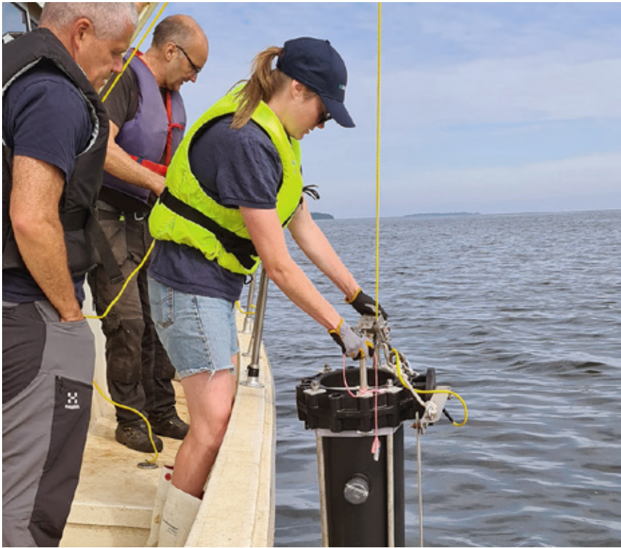
Torsklarverna förs försiktigt ned i utsättningsenheten. Enheten försluts och sänks ned till avsett djup där den öppnas och larverna släpps ut.
